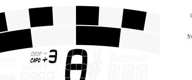
Appuyez sur le bouton MENU deux fois ou jusqu'à ce que la valeur de transposition Descente ou Capo clignote. Utilisez les boutons +/- pour choisir une valeur entre -6 et +5. Appuyez brièvement sur les boutons + et - ensemble pour repasser rapidement au réglage par défaut. (0)
