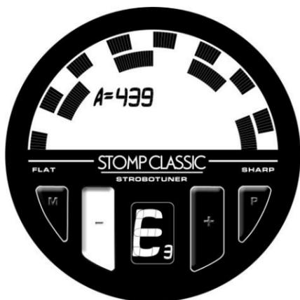
Le Stomp Classic peut être calibré entre A=390Hz et to A=490Hz par échelons de 1Hz.
